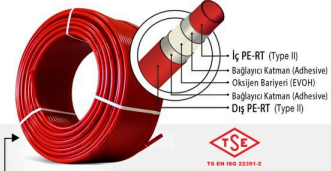
Gerçek Oksijen Bariyerli 5 Katmanlı PE-RT Borular
